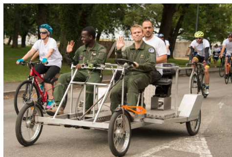
Rosalie, système à pédale permettant de faire monter un fauteuil roulant à bord
