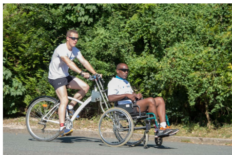
Vélo avec le guidon HCP, permettant l'accroche d'un fauteuil roulant à l'avant.
